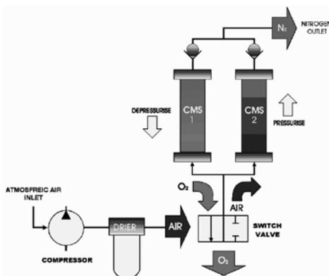
Dans le même temps, l'autre colonne est régénérée par dépressurisation automatique. C'est ce qu'on appelle la désorption. Pour aider à la production d'azote, 2 colonnes remplies de tamis moléculaires sont utilisées alternativement. L'air entre dans les colonnes et évacue l'oxygène par désorption.
